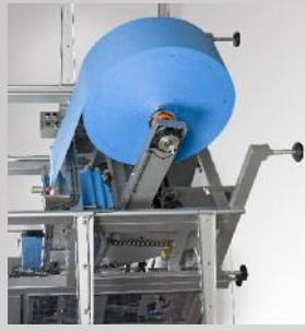
Rollenabwicklung für Großrollen bis \varnothing 1,2 m
